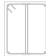
Beispiel 6: Kompaktquerschnitt (Balken bzw. Plattenbalken)
