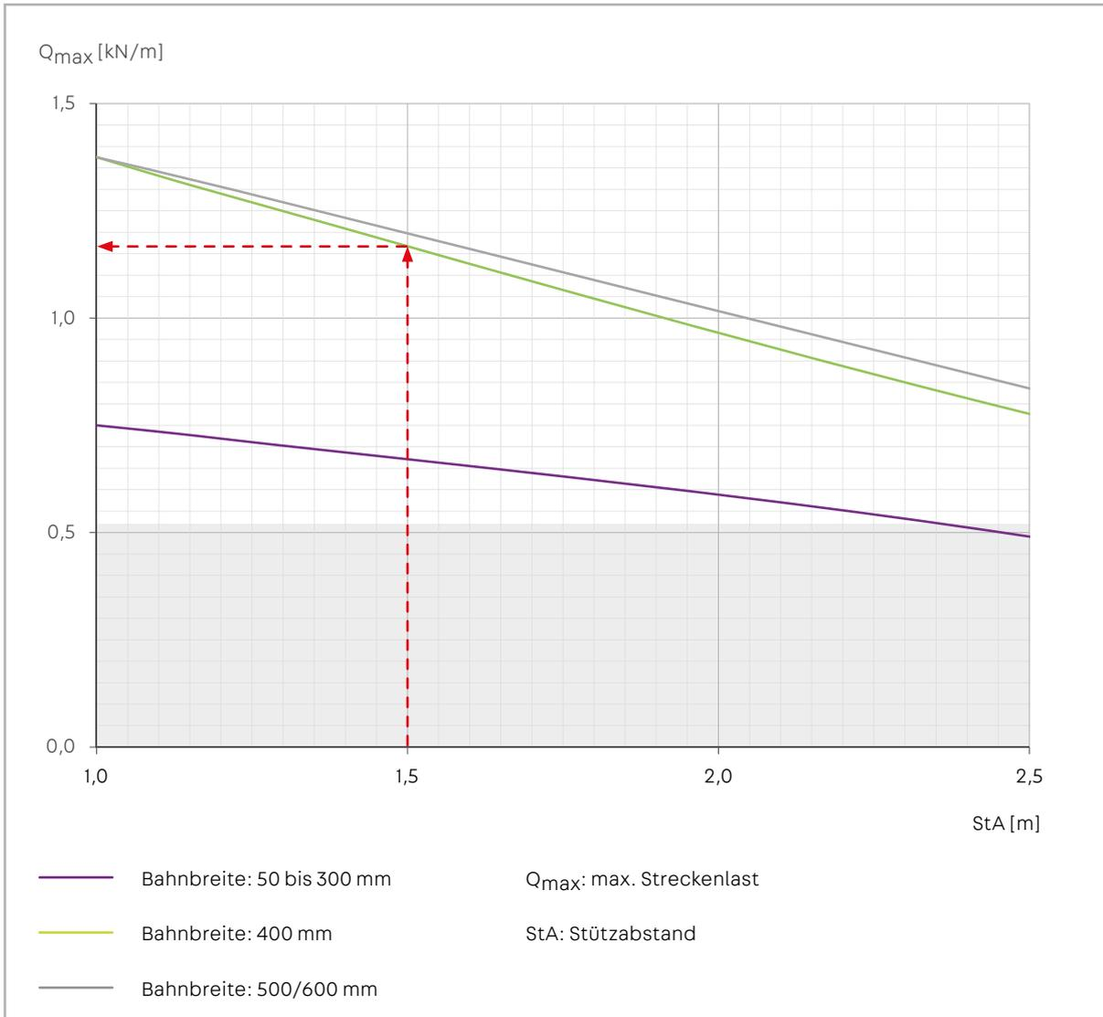
Abbildung 1: Belastungsdiagramm RG 60 mit eingezeichnetem Stützabstand von 1,5 m
