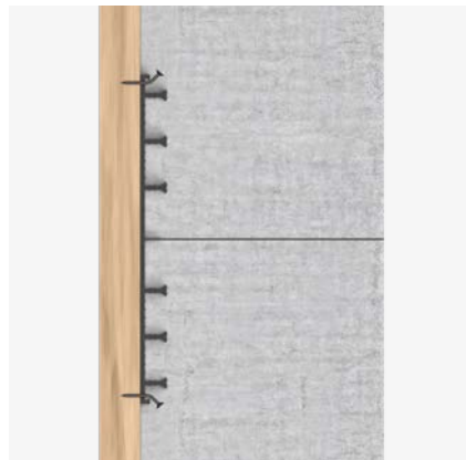
Arbeitsfuge Wand-Wand: Befestigung an der Schalung.
