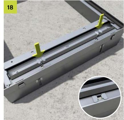
Eine Traverse wird zur Stabilisierung eingesetzt und mit zwei Federklemmbefestigungen am Endstück fixiert. Mitgelieferte Nivellierschrauben M10 vor der Montage der Traverse einschrauben.
