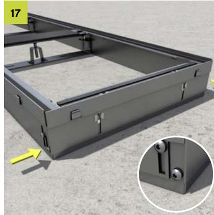
Über die seitlichen Befestigungsschrauben wird das Endstück beidseitig unten am Kanal fixiert.
