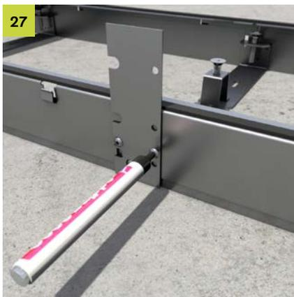
Schablone wird benötigt, wenn der Kanal gekürzt wurde. Den geschnittenen Kanal an das Ende des ungeschnittenen Kanals anlegen und auf gleiche Höhe nivellieren. Schablone beidseitig über die Schrauben legen und den Schraubenköpfen gegenüber Bohrungen ( $\varnothing$  6 mm) setzen. Geschnittenen Kanal mit der Nivellierstütze verschrauben.
