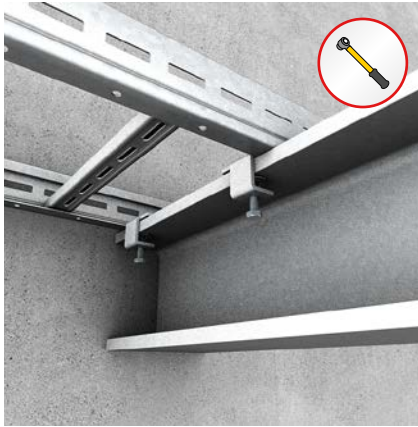
Klemmbefestigung (KLUT) KLUT für Kabelleitern von unten an den Stahlkörper verschrauben. Gilt nur zur Lagesicherung.
