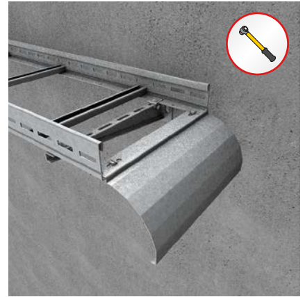
Leiterabgangsblech (LGKAB) LGKAB auf gewünschte Sprosse auflegen und zweifach mit Anker Mutter (AM16 M6) und Flachkopfschraube (FKS 6x10) auf der Sprosse verschrauben.
