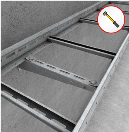
Befestigung Kabelleiter LGG auf Konsole mit Klemmbefestigung (KLU) Kabelleiter mit KLU zweimal auf Konsole verschrauben.
