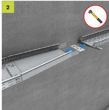
Anschlusskabelrinne mit Bodenverbinder (VB) in die Kabelrinnenreduzierung (RR) einschieben und wie RGV verschrauben.
