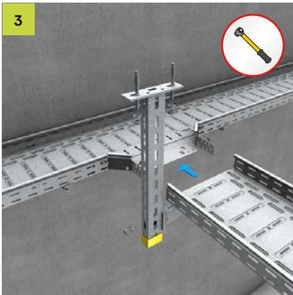
Anschlusskabelrinne mit Bodenverbinder (VB) in den RAA einschieben und wie Rinnenseitenverbinder (RGV) verschrauben.
