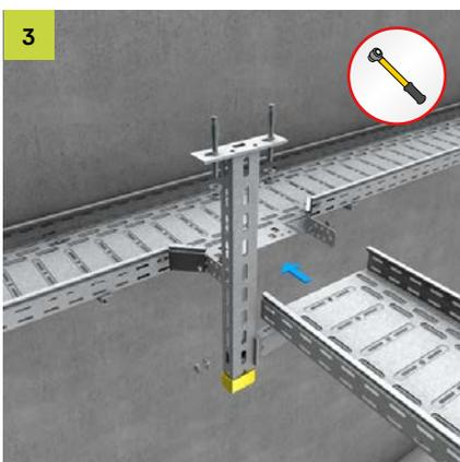
Anschlusskabelrinne je Holm um 60 mm zurückschneiden, auf die Anbauecken schieben und je Holm verschrauben.
