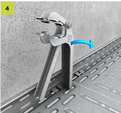
Zur Demontage die einzelnen Laschen des RGVS 60 mit den Haken am RGVST lösen.
