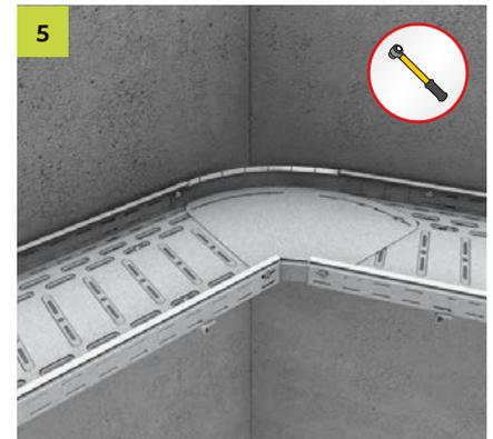
Die weiterführende Kabelrinne anschließend genauso wie die erste Rinne verschrauben. RBV mit  $B \geq 400$  mm sind durch eine zusätzliche Tragkonstruktion mittig unter dem RBV zu stützen.
