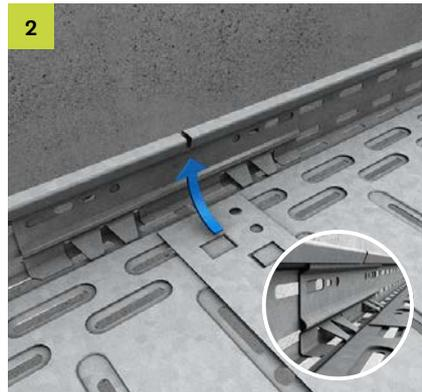
Die Kabelrinne Höhe 60 mittels RGVS 60 beidseitig innenliegend unter dem Seitenholmkopf verbinden. Der RGVS 60 wird gegen den Rinnenboden gedrückt bis ein Verrasten im Rinnenboden erfolgt.
