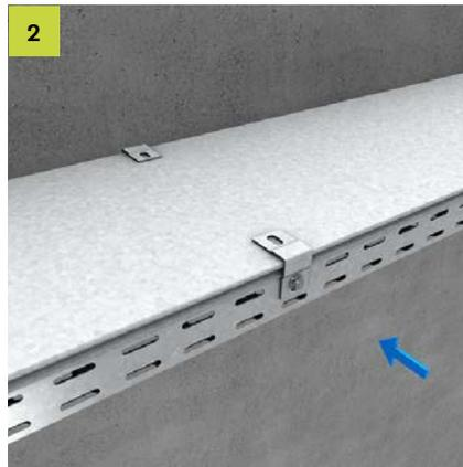
RD auf der Kabelrinne auflegen, den RD-SW von außen auf den Deckel aufsetzen und mit der Flanschmutter (SEMS 6) verschrauben. 6 Stück alle 3 Meter. Lage der Sturmsicherungswinkel: 100-150 mm vor den Enden und mittig der Kabelrinne.
