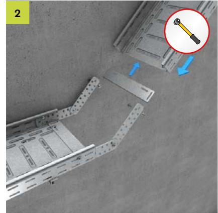
REB in den Boden der Anschlusskabelrinne einschieben und wie RGV verschrauben. Anschließend in die RGV einschieben und verschrauben. Ausführung als Steig- oder Fallstück möglich.
