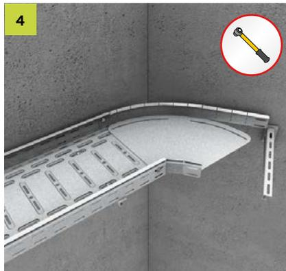
RBV in die erste Kabelrinne schieben. Holm mit KLR sowie die Böden verschrauben.
