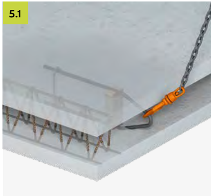
5.1 Randferner Einbau: Bei Querkzug Gitterträger als Randeinfassung
