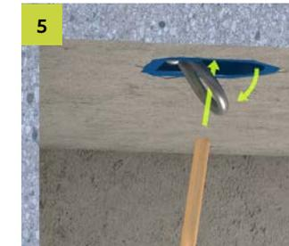
Ausklappen des Schäkels durch Drücken auf die Entriegelungsplatte.
