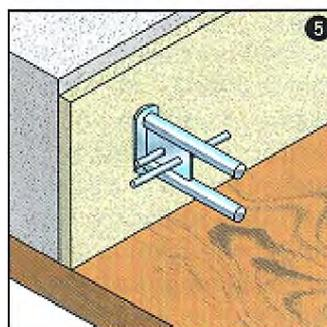
Das Dornenelement des Doppelschubdornes JDSD oder JDSDQ wird durch die Isolierung in die Hülse geschoben. Ein Verschieben des Dornes während des Betonierens ist durch die im Gleitrohr befindliche Klemmdruckstelle verhindert.
