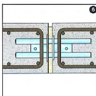
Verlegen der bauseitigen Anschlussbewehrung gemäß Bewehrungsplan und Betonieren.
