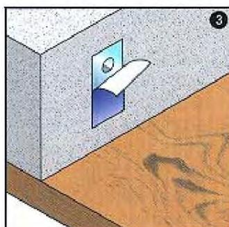
Nach dem Ausschalen wird der Aufkleber entfernt oder durchstoßen.
