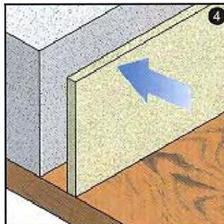
Das Fugenmaterial wird angebracht. Bei Verwendung von Brandschutzmanschetten ist in das Fugenmaterial eine entsprechende Ausparung zu schneiden und die Brandschutzmanschette einzusetzen.
