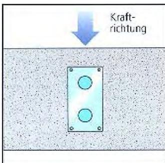
Auf die richtige Orientierung der Hülse zur Krafrichtung ist zu achten. Der Aufkleber darf nicht entfernt werden. Er verhindert das Eindringen von Beton
