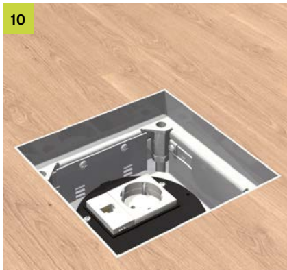
10 Einbau Installationsgeräte In Abdeckplatte UARM-3-1118 ein Installationsgerät 45 x 45 mm und ein Installationsgerät 22,5 x 45 mm einrasten.
