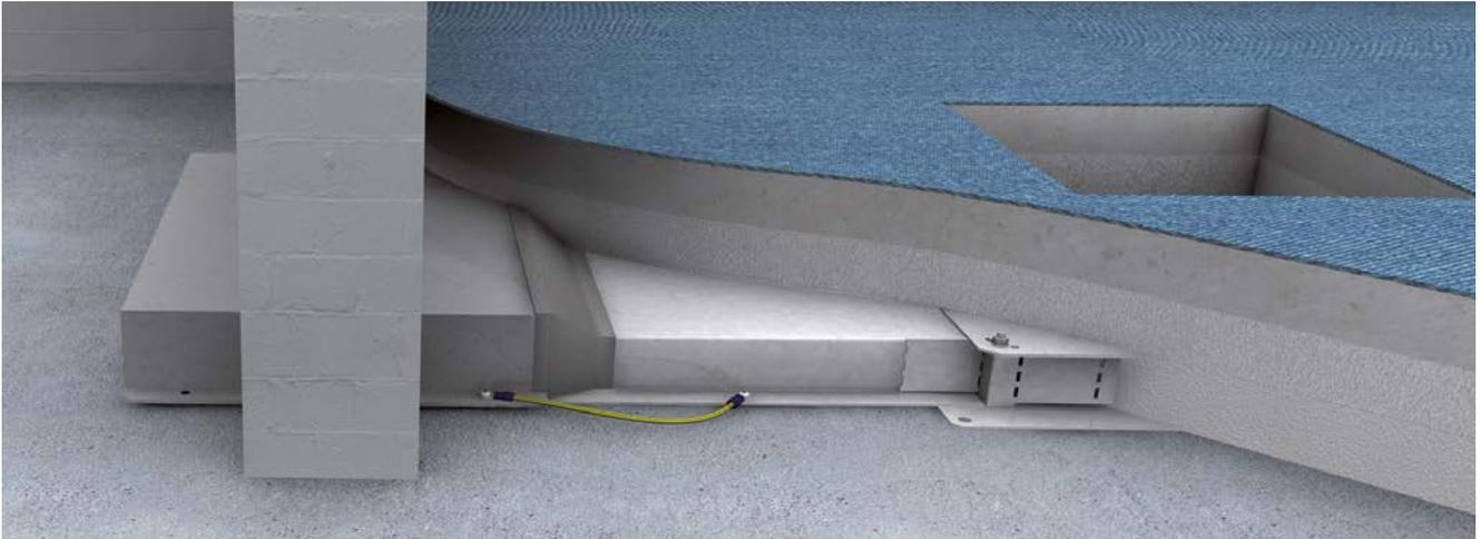
Brandschutzschott (Kabelschottung WD90, System Wichmann) für estrichüberdeckte Unterflurkanäle mit einer Breite von 350 mm und in den Höhen 28, 38 bzw. 48 mm. Andere Abmessungen auf Anfrage. Zum Einbau in Brandschutzwände der Feuerwiderstandsklasse S90.
