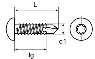
Quelle: DIN 7504 Form M(N) Bohrschrauben mit Linsenkopf und TX-Antrieb
