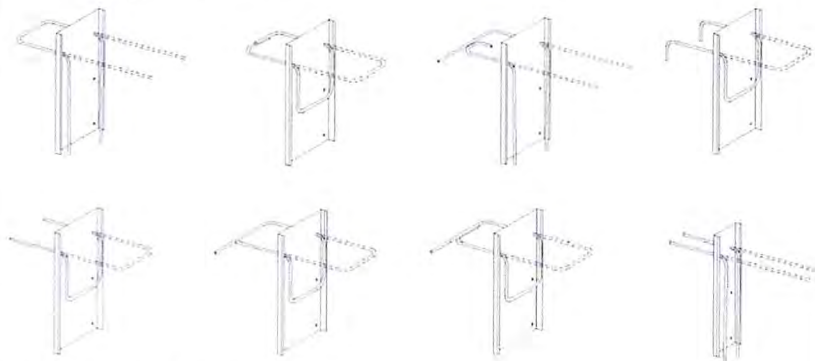
Abbildung 4: Biegeformen der Rückbiegebewehrung, Beispiele
