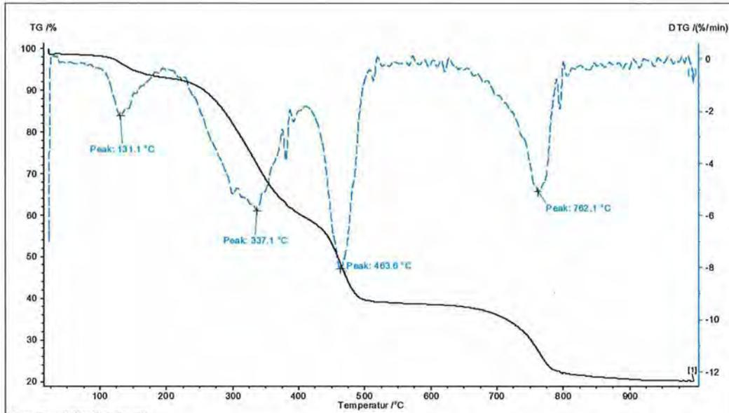
Die thermogravimetrische Analyse wurde in Anlehnung an DIN EN ISO 11358 durchgeführt. Die Aufheizrate betrug 20K/min. Die Messung erfolgte unter Stickstoffatmosphäre im Temperaturbereich von 25° bis 1000 °C bestimmt.
