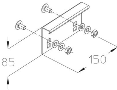
Deckelerhöhung zur Aufständigung von Weitspannbahndeckeln (6 WPD-A/3m). Die Deckel sind mit Deckelklammern im Abstand von 100 mm von den Deckelenden und in der Mitte zu sichern (6 WPDUK/3m). In windexponierten Bereichen muss die Anzahl auf mindestens zehn WPD-A und WPDUK je 3 m erhöht werden. Im Innenbereichen ist die Sicherung mit Deckelklammern optional. Das Füllvolumen der Trasse bleibt unverändert.
