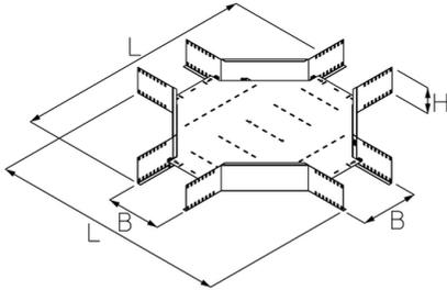
Die Weitspannkabelrinnen-Kreuzung WLRK 200 mit integrierten Verbindern dient als Formteil für sich horizontal kreuzende Weitspannkabelrinnen. Sie eignet sich für die Weitspannkabelrinnen WLR 200 und weist Breiten von 200 bis 600 mm auf. Die Anschlussrinnen lassen sich mit einem Bodenverbinder VB einschieben. Verschiedene Materialien und Oberflächen sorgen dafür, dass die Korrosionsschutzanforderungen unterschiedlichster Anwendungsgebiete erfüllt werden.
