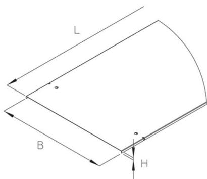
Dieser Deckel ist für Weitspannsysteme WL 200 und WLR 200 geeignet. Sie verfügen zusätzlich über Drehriegel zur weiteren Befestigung an den Weitspannsystemen. Sollen die Deckel im Freien eingesetzt werden, sind zusätzliche Sicherungswinkel gegen Windeinflüsse nötig. Die Drehriegel allein stellen für diesen Fall kein ausreichendes Sicherungselement dar.
