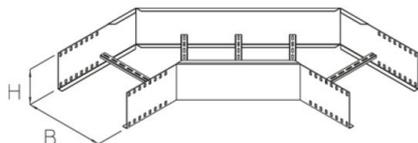
Formteile müssen an allen Seiten unterstützt werden.
