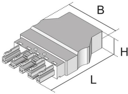
5-poliges Buchsenteil mit Zugentlastungsgehäuse und schraubenlosem Steckanschluss für ein- und feindrähtige Leitungen von 0,5 bis 4,0 mm<sup>2</sup> bzw. mehrdrähtige Leitungen von 0,5 bis 2,5 mm<sup>2</sup>, 400 V/ 6 kV/25 A.
