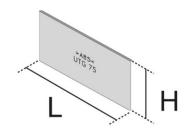
Gerätetrennwand aus ABS zur Trennung verschiedener Stromarten innerhalb eines Gerätebechers.
