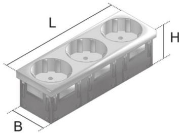
Einteilig rastbare, dreifache Schutzkontaktsteckdose in 45x45 mm Ausführung aus Kunststoff mit 33° Steckrichtung, Steckklemmen, erhöhter Berührungsschutz gemäß VDE 0620 und Nennspannung/-Strom: AC 250 V, 10/16 A.
