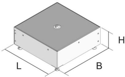
Schalungskörper nivellierbar, viereckig, in Bodendosen oder Kabelkanal-Montagedeckel, bestehend aus einem sendzimirverzinktem Stahlblechrahmen, einer innenliegenden Nivellierung mit Nivellierfüßen und Deckel. Als verlorene Schalung für viereckige Einbaueinheiten, überschleifbar und wärmefest. Für den Einbau in Guss-/Heissasphalt bzw. Terrazzo geeignet.
