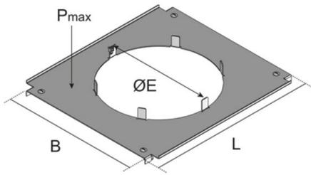
Montagedeckel aus sendzimir-feuerverzinktem Stahlblech zum Auflegen auf die Seitenprofilierung des Kabelkanalunterteils inkl. Drehriegel. Verwendbar als Zug- und Einbaudose, mit einer Einbauöffnung zur Aufnahme eines Schalungsrohres, das bei der Endmontage durch eine runde Einbaueinheit ersetzt wird.
