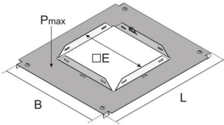
Montagedeckel aus sendzimir-feuerverzinktem Stahlblech zum Aufrasten auf die Seitenprofilierung des Kabelkanalunterteils inkl. Drehriegel. Verwendbar als Zug- und Einbaudose, mit einer Einbauöffnung zur Aufnahme eines Schalungskörpers, der bei der Endmontage durch eine viereckige Einbaueinheit ersetzt wird.
