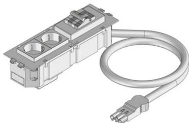
Vormontierter Gerätebecher mit einem FI/LS-Schalter 6 KA, 1 p?+?N, 10 A/30 mA, angeschlossen an eine Anschlussleitung 3x4 mm<sup>2</sup> mit 3-pol. Wieland Stecker. Komplett mit einer 3-pol. Wieland Snap-In-Gerätebuchse unter dem Gerätebecher und einer zweifachen Steckdose.
