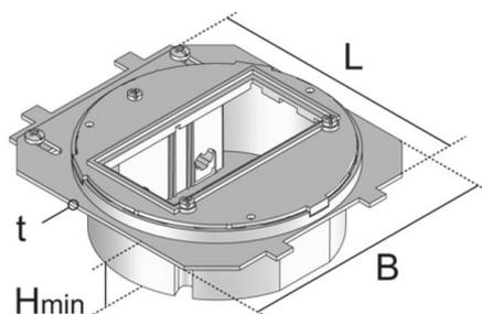
Runder Gerätebecher bestehend aus einer Platine UGET1-2 UG-R, einem Gerätebecher UG-R inklusive Zugentlastungen und einer Abdeckplatte UARM-4-1 118 zum Einbau von bis zu 2 Installationsgeräten 45x45mm. Zur höhenunabhängigen Verrastung in Einzelauslässen, die zur Montage in Hohlraumbodendosen bestimmt sind.
