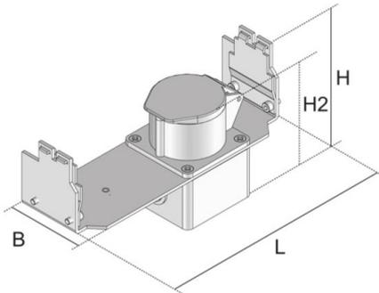
Geräteträger aus verzinktem Stahlblech mit CEE-Steckdose und Befestigungsklemmen zum Einsetzen in eine Einbaueinheit. Der Einbau erfolgt mittig anstelle eines Gerätebeckers. Die Verwendung eines Winkelsteckers wird empfohlen. Optional Rastverlängerung. Benötigte Einbauhöhe  $H_{min}$  im Estrich beachten.
