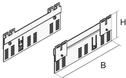
Rastleiterverlängerungsset aus sendzimir-feuerverzinktem Stahlblech bestehend aus zwei einzelnen Rastleitern zur zusätzlichen Absenkung von bis zu 3 Gerätebechern oder Geräteträgern. Montage an Einbaueinheiten.
