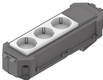
Vorkonfektionierter Gerätebecher komplett mit einem 3-pol. Wieland Snap-In-Gerätestecker und einer dreifachen vorverdrahteten Steckdose. Geeignet für 3-polige Anschlussleitung Stecker-Buchse. Inklusive aller Abdeckungen und Montagematerialien. Mit Anschlussmöglichkeit im Bodenbereich des Gerätebeckers.
