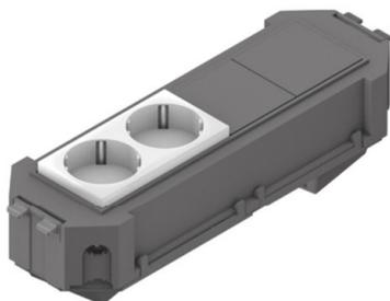
Vorkonfektionierter Gerätebecher komplett mit einem 3-pol. Wieland Snap-In-Gerätestecker und einer zweifachen vorverdrahteten Steckdose. Geeignet für 3-polige Anschlussleitung Stecker-Buchse. Inklusive aller Abdeckungen und Montagematerialien. Mit Anschlussmöglichkeit im Bodenbereich des Gerätebeckers.
