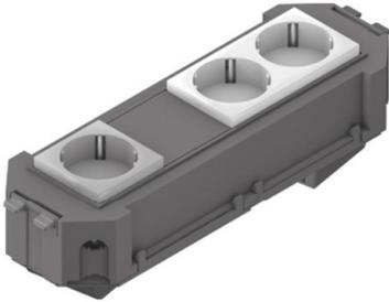
Vorkonfektionierter Gerätebecher komplett mit zwei 3-pol. Wieland Snap-In-Gerätesteckern und einer zweifachen sowie einer einfachen vorverdrahteten Steckdose. Geeignet für 3-polige Anschlussleitung Stecker-Buchse. Inklusive aller Abdeckungen und Montagematerialien. Mit Anschlussmöglichkeit im Bodenbereich des Gerätebeckers.
