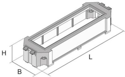
Gerätebecher schwarz aus Kunststoff, zum einrasten in eine Einbaueinheit, bestehend aus einer einteiligen Schale mit Zugentlastungseinrichtung für ankommende Leitungen und offenem Boden. Geeignet zum Einbau von bis zu vier 45x45 mm Installationsgeräten. Boden optional verschließbar mit Blindabdeckung.
