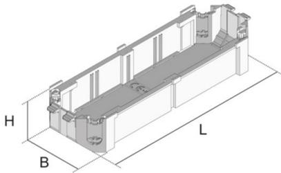
Gerätebecher schwarz aus Kunststoff, zum Einrasten in eine Einbaueinheit, bestehend aus einer einteiligen Schale mit Zugentlastungseinrichtung für ankommende Leitungen und mit perforiertem Boden. Geeignet zum Einbau von bis zu 4 Installationsgeräten 45x45mm bzw. 3 Hängebügelinstallationsgeräten.
