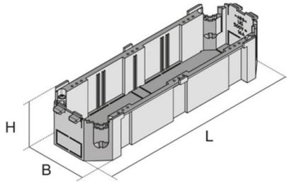
Gerätebecher schwarz aus Kunststoff, zum Einrasten in eine Einbaueinheit, bestehend aus einer einteiligen Schale mit Zugentlastungseinrichtung für ankommende Leitungen und mit perforiertem Boden. Geeignet zum Einbau von 3 Einzel- oder 4 rastbaren Modulinstallationsgeräten und 2 Snap-In-Gerätestecker.
