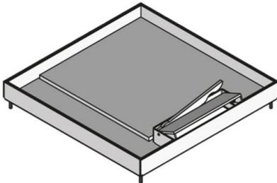
Viereckige Kassette aus Edelstahlblech mit Stoßkante. Als Kassetteneinbaurahmen mit Kabelauslass-Kassette, Stahleinlage, bodenebenem Leitungsauslass, selbstschließendem Öffnungshebel, Gummidichtung und Befestigungsschrauben zum Aufbau auf Nivelliereinheiten in Bodendosen, Montagegedeckeln und Doppel- oder Hohlraumbodenöffnungen.
