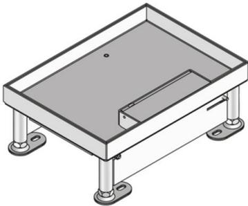
Viereckige Kassetteneinheit aus Edelstahlblech mit Stoßkante. Als nivellierbare Einbaueinheit mit Kabelauslasskassette, selbstschließendem Öffnungshebel, bodenebenem Leitungsauslass und Gummidichtung. Zum Einsatz in Bodendosen und Doppel- oder Hohlraumbodenöffnungen. Zur Aufnahme von maximal 2 Gerätebechern bestückt mit bis zu 6 Hängebügelinstallationsgeräten oder 8x Installationsgeräte 45x45mm. Für Räume mit trocken und feucht gepflegten Bodenbelägen geeignet. Ausgelegt für Büroverkehrslasten.
