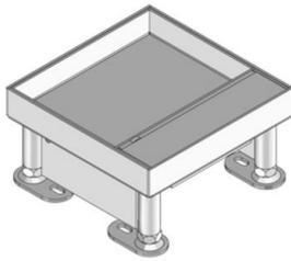
Viereckige Bodeneinbaueinheit mit Stoßkante zur Aufnahme von zwei 45x45mm Einbaugeräten. Als nivellierbarer Kassetteneinbaurahmen mit Kabelauslasskassette, selbstschließendem Öffnungshebel, bodenebenem Leitungsauslass und Gummidichtung. Für Räume mit trocken gepflegten Bodenbelägen geeignet. Ausgelegt für Büroverkehrslasten.
