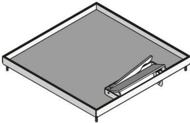
Viereckige Kassette aus Edelstahlblech mit Stoßkante. Als Kassetteneinbaurahmen mit Einlagekassette, Kabelauslass, bodenebenem Leitungsauslass, selbstschließendem Öffnungshebel und Gummidichtung. Zum Aufbau auf Nivelliereinheiten in Bodendosen, Montagendeckeln und Doppel- oder Hohlraumbodenöffnungen.
