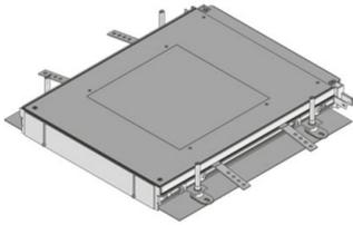
Anbaumontagedeckelset, dreifach, aus Stahlblech, vormontiert auf Aluminiumseitenprofil mit verschraubter Traverse, blind verschlossener Montageöffnung und Endstück. Ausgelegt für Büroverkehrslasten.
