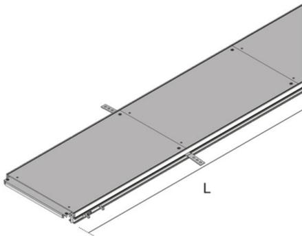
Estrichbündiger Kanal, offenes System mit abnehmbaren Deckeln für die horizontale Leitungsführung. Besteht aus vormontierten Aluminiumseitenprofilen mit Gummidichtung, Blinddeckeln aus Stahlblech, Traversen, Estrichankern und Teppichprofilen. Separierbar durch Trennstege.
