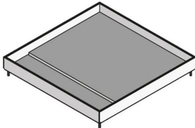
Viereckige Kassette aus Edelstahlblech mit Stoßkante. Als Kassetteneinbaurahmen mit Blind-Schwerlastkassette, Gummidichtung und Befestigungsschrauben. Zum Aufbau auf Nivelliereinheiten in Bodendosen, Montagedeckeln und Doppel- oder Hohlraumbodenöffnungen. Für Räume mit nass gepflegten Bodenbelägen geeignet. Ausgelegt für hohe Verkehrslasten.
