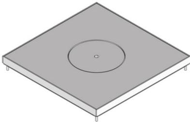
Viereckige Kassette aus Edelstahlblech, plane Oberfläche gestrahlt. Als Kassetteneinbaurahmen mit Tubusauslasskassette, verschraubtem Tubusmontagesatz und Gummidichtung. Zum Aufbau auf Nivelliereinheiten. Zur Aufnahme von maximal 3 Gerätebechern bestückt mit bis zu 9 Hängebügelinstallationsgeräten oder 12x Installationsgeräte 45x45 mm. Für Räume mit nass gepflegten Bodenbelägen geeignet. Ausgelegt für Büroverkehrslasten.
