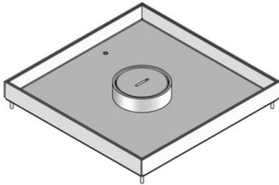
Viereckige Kassette aus Edelstahlblech mit Stoßkante. Als nivellierbarer Kassetteneinbaurahmen mit Tubusauslasskassette, verschraubtem Aluminiumtubusmontagesatz und Gummidichtung zum Einbau in Bodendosen, Montagedeckeln und Doppel- oder Hohlraumbodenöffnungen.
