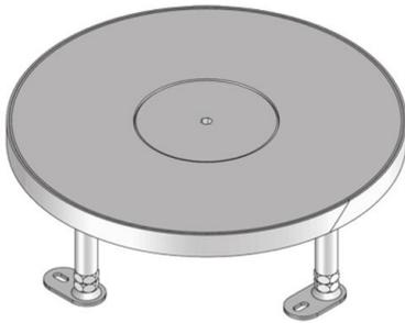
Runde Kassette aus Edelstahlblech, plane Oberfläche gestrahlt, mit Stoßkante. Als nivellierbarer Kassetteneinbaurahmen mit Tubusauslasskassette, verschraubtem Tubusmontagesatz und Gummidichtung zum Einbau in Bodendosen, Montagedeckeln und Doppel- oder Hohlraumbodenöffnungen. Zur Aufnahme von maximal 3 Gerätebechern bestückt mit bis zu 9 Hängebügelinstallationsgeräten oder 12x Installationsgeräte 45x45 mm. Für Räume mit nass gepflegten Bodenbelägen geeignet. Ausgelegt für Büroverkehrslasten.
