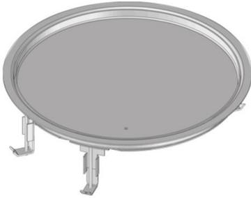
Runde Einbaueinheit mit Edelstahlbodenbelagsschutzrahmen. Als Kassetteneinbaurahmen mit Blind-Einlagekassette, Gummidichtung und Universalbefestigungskrallenset. Zum Einsatz in Bodendosen, Montagedeckel, Doppel- oder Hohlraumbodenöffnungen. Für Räume mit trocken und feucht gepflegten Bodenbelägen geeignet. Ausgelegt für Büroverkehrslasten.
