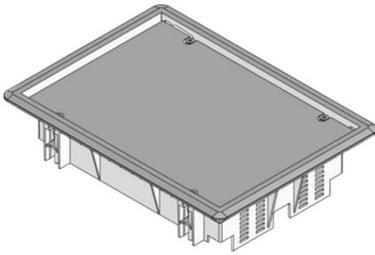
Viereckige Blindeinheit aus Polyamid mit Teppichschutzrahmen. Als Einbaurahmen mit Stahlblecheinlage, inklusive Universalbefestigungskrallenset. Zum Einsatz in Bodendosen, Montagegedeckel, Doppel- oder Hohlraumbodenöffnungen. Für Räume mit trocken gepflegten Bodenbelägen bis 8 mm geeignet. Ausgelegt für Büroverkehrslasten.
