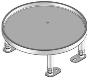
Runde Kassette aus Edelstahlblech mit Stoßkante. Als nivellierbarer Kassetteneinbaurahmen mit Blind-Einlagekassette und Gummidichtung zum Einbau in Bodendosen, Montagegedekeln und Doppel- oder Hohlraumbodenöffnungen. Für Räume mit nass gepflegten Bodenbelägen geeignet. Ausgelegt für Büroverkehrslasten.
