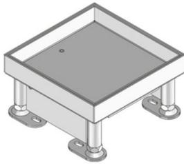
Viereckiger Einzelauslass aus Edelstahlblech mit Stoßkante zur Aufnahme von zwei 45x45 mm Einbaugeräten. Als nivellierbarer Kassetteneinbaurahmen mit Blindkassette und Gummidichtung. Zum Einbau in Bodendosen und Doppel- oder Hohlraumbodenöffnungen. Für Räume mit nass gepflegten Bodenbelägen geeignet. Ausgelegt für Büroverkehrslasten.
