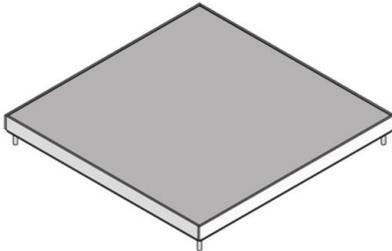
Viereckige Kassette aus Edelstahlblech, plane Oberfläche gestrahlt. Als Kassetteneinbaurahmen mit Blind-Einlagekassette, Gummidichtung und Befestigungsschrauben zum Aufbau auf Nivelliereinheiten, in Bodendosen, Montagegedeckeln und Doppel- oder Hohlraumbodenöffnungen. Für Räume mit nass gepflegten Bodenbelägen geeignet. Ausgelegt für Büroverkehrslasten.
