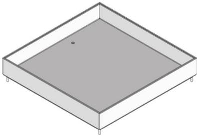
Viereckige Kassette aus Edelstahlblech mit Stoßkante. Als Kassetteneinbaurahmen mit Blind-Einlagekassette, Gummidichtung und Befestigungsschrauben zum Aufbau auf Nivelliereinheiten, in Bodendosen, Montagedeckeln und Doppel- oder Hohlraumbodenöffnungen. Für Räume mit trocken und nass gepflegten Bodenbelägen geeignet. Ausgelegt für Büroverkehrslasten.
